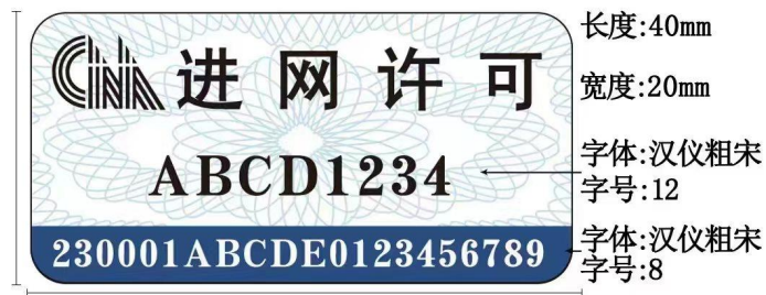
图3 新型进网许可标志标准规格尺寸示意图
